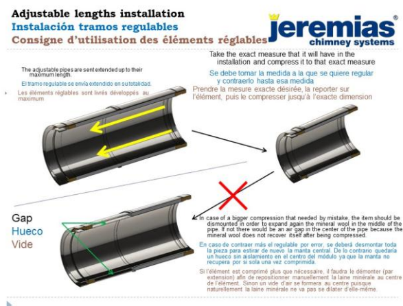
Figure 3-7 : Indications pour l'utilisation des éléments réglables
